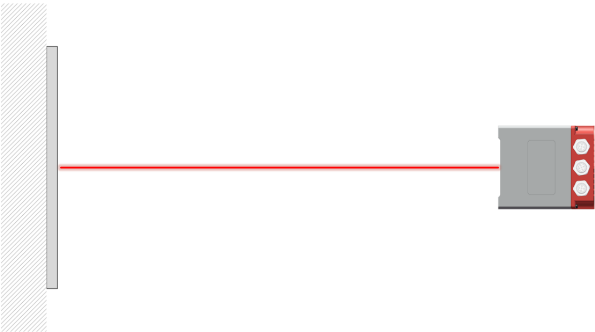
图 4.3: 激光测距传感器及反射板安装示意
