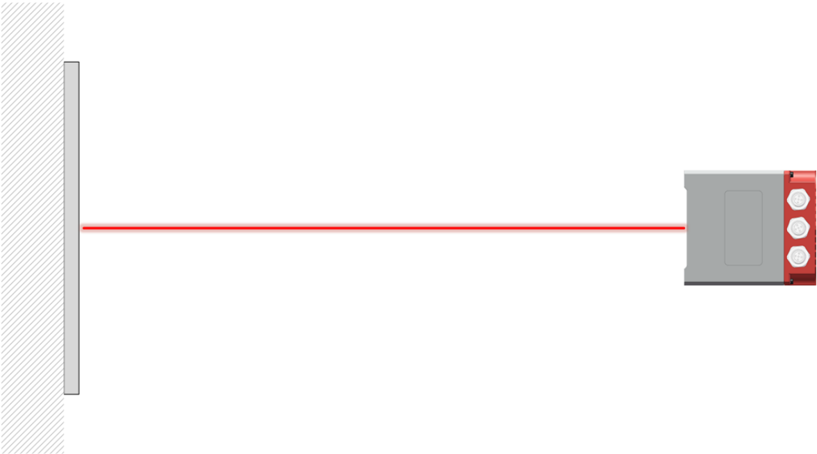
图 4.3: 激光测距传感器及反射板安装示意
